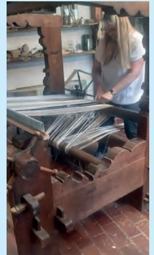
Bündelweise werden die Kettfäden an eine vordere Holzleiste geknotet. Diese angeknottete Webkette wird dann zum unteren Warenbaum geleitet, der das fertig gewebte Tuch aufwickelt.
