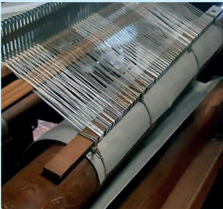
Mit Hilfe einer Leiste werden sie nun am Kettbaum des Webstuhls befestigt.
