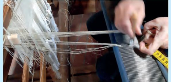
Jetzt wird's knifflig und es braucht Zeit: jeder einzelne Faden wird zunächst durch die kleine Öse einer Litze gezogen – immer im Wechsel eine Litze des vorderen und des hinteren Schafts. Im nächsten Arbeitsschritt werden die Fäden durch das Riet – den Kamm – gestochen.
