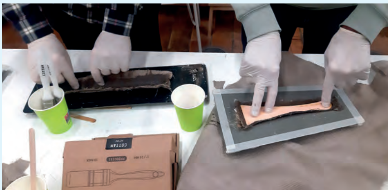
Grundlage ist feingewebtes Leinen, mit Harzmischung bestrichen und in die vorgefertigte Form gepresst. Die Ergebnisse unserer Probe-Arbeiten sind übrigens inzwischen in der Ausstellung im Flachsmuseum zu sehen.
