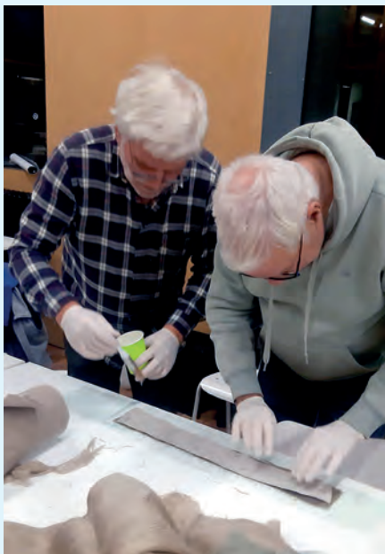
Grundlage ist feingewebtes Leinen, mit Harzmischung bestrichen und in die vorgefertigte Form gepresst. Die Ergebnisse unserer Probe-Arbeiten sind übrigens inzwischen in der Ausstellung im Flachsmuseum zu sehen.
