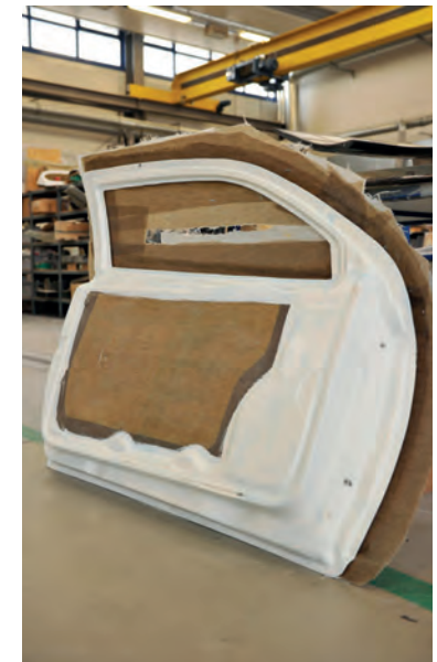
Außen- und Innenteil einer Autotür aus Flachsfasern und Harzgemisch
